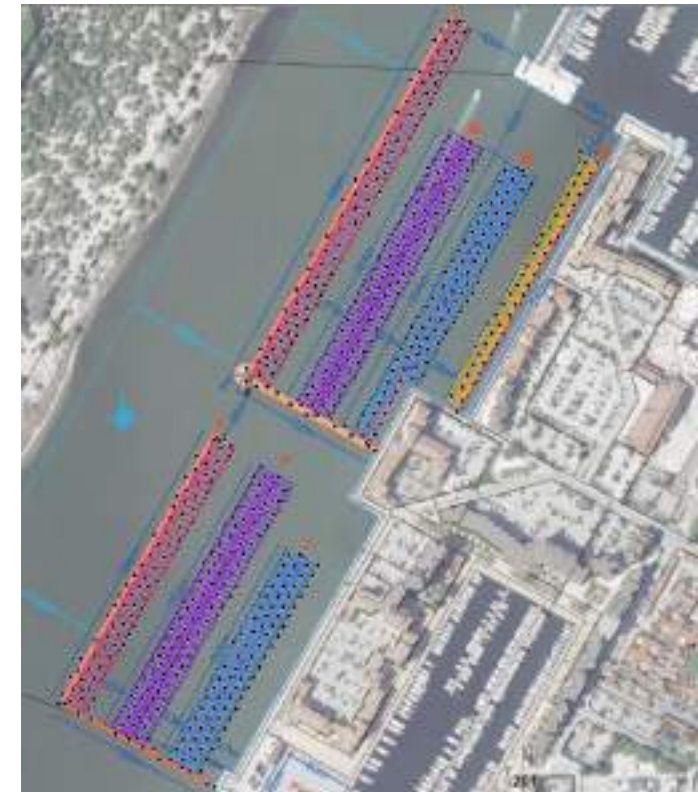
Position des pontons (et bateaux) et nœuds correspondants dans le modèle
